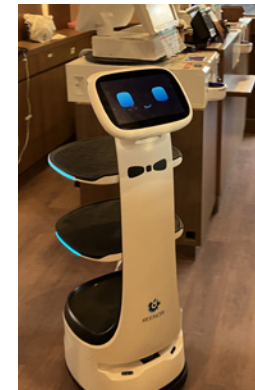
▲配膳ロボットによる 食器回収を検証
